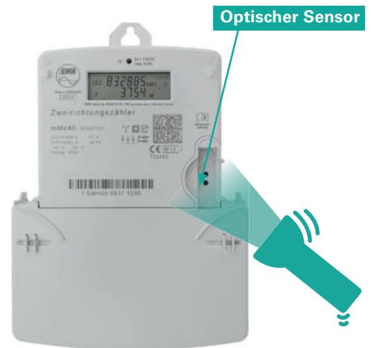
Hinweis<sup>1</sup>: Nach dem Ersteinbau des Zählers oder einem Stromausfall folgt nach dem Anleuchten des optischen Sensors ein Displaytest und die Anzeige 0\_2\_0 / FW-Version. Sollte dies der Fall sein, geben Sie solange kurze Signale auf den optischen Sensor bis im Display die Anzeige INFO. U1 / Wert U1 erscheint. Dann leuchten Sie für mindestens 5 Sek auf den optischen Sensor und warten. Anschließend erscheint das Feld für die PIN-Eingabe. Dann folgen Sie weiter der Anleitung ab Schritt 2.
